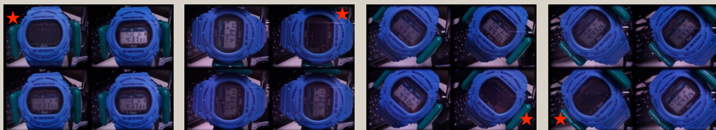
マルチ偏光複眼カメラPiTOMBO-MPLによる撮影例：腕時計の液晶表示が特定★個眼で消失している
